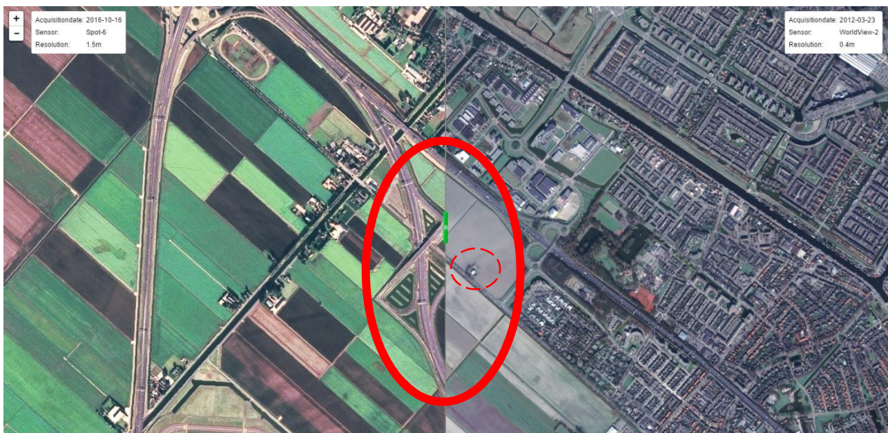
Attēls 16, Izmaiņu analīze – uzbūvēts jauns ceļš un nojaukta ēka - salīdzināti 2016. (kreisajā pusē) un 2012. (labajā pusē) gadu attēli (apstrādāti)
