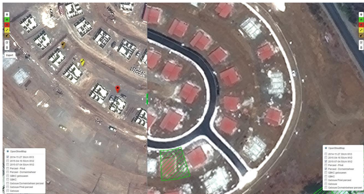
Attēls 17, Izmaiņu analīze – identificēti rakšanas darbi, nelegālā būvniecība un jauna ēka - salīdzināti 2014. (kreisajā pusē) un 2015. (labajā pusē) gadu attēli (apstrādāti)
